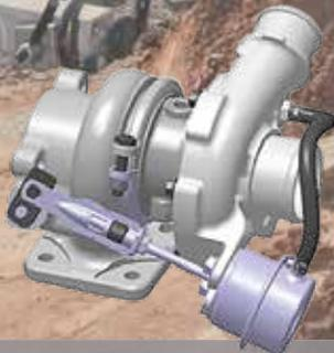
**Turbocompresor con válvula de descarga:** desvía los gases de escape de la turbina para regular mejor la presión máxima de sobrealimentación y proteger el motor. También disminuye el tiempo que pasa antes de que el turbo comience a girar/generar fuerza que maximice el par y además reduce el desgaste en condiciones de régimen elevado y baja carga. El turbocompresor aumenta la densidad del aire, lo que permite al motor producir más potencia sin que influya mucho la altitud.
