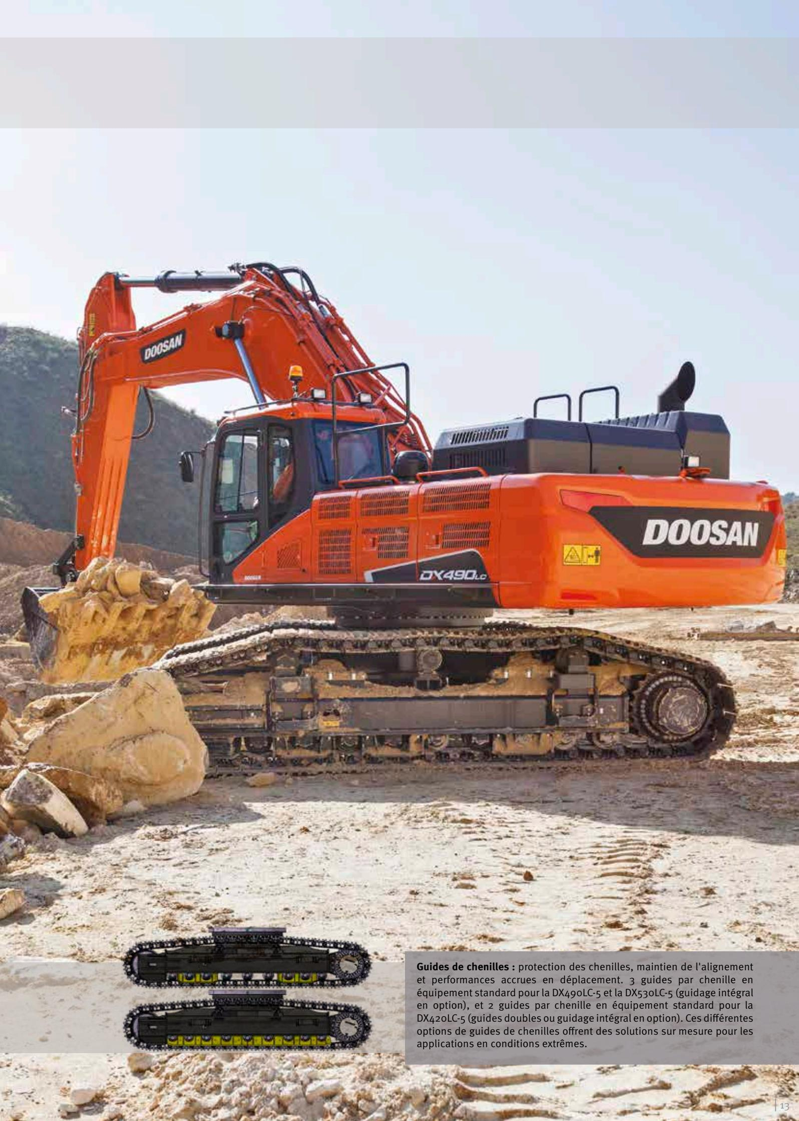
**Guides de chenilles :** protection des chenilles, maintien de l'alignement et performances accrues en déplacement. 3 guides par chenille en équipement standard pour la DX490LC-5 et la DX530LC-5 (guidage intégral en option), et 2 guides par chenille en équipement standard pour la DX420LC-5 (guides doubles ou guidage intégral en option). Ces différentes options de guides de chenilles offrent des solutions sur mesure pour les applications en conditions extrêmes.
