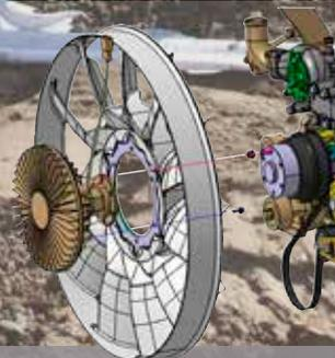
**Ventilateur à régulation électronique :** Entraîne le ventilateur de refroidissement au régime optimum. Le régime du ventilateur est contrôlé électroniquement en fonction des températures du liquide de refroidissement, de l'huile hydraulique et de l'air d'admission, et du régime moteur sélectionné. Le bruit généré par le ventilateur est nettement réduit ainsi que la consommation de carburant.
