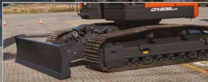
Lame de remblayage et châssis inférieur ultra robustes
