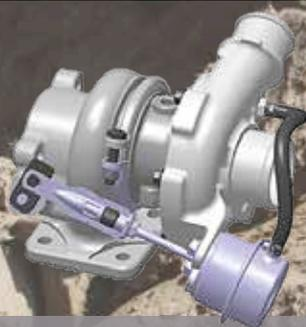
**Turbocompresseur à clapet de décharge :** Augmente la densité de l'air, permettant au moteur de développer plus de puissance et de se montrer moins sensible aux effets de l'altitude. Le clapet de décharge contrôle la quantité de gaz d'échappement qui entraîne la turbine du turbocompresseur, de sorte à réguler la pression de suralimentation et protéger le moteur. Augmente également la réactivité du moteur. Réduit l'usure à hauts régimes et à faibles charges.
