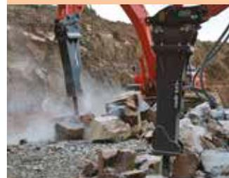
Marteaux hydrauliques Doosan et attaches rapides Doosan
