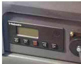
Calentador del refrigerante del motor
