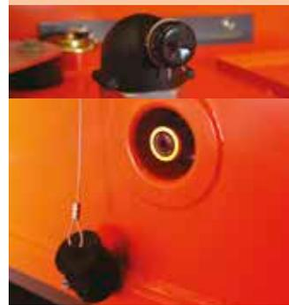
Système de remplissage rapide de carburant
