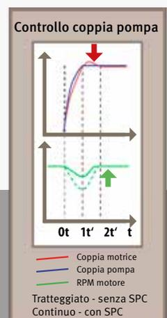
**SPC (Smart Power Control):** 2 sistemi (regolazione del regime motore e della coppia della pompa) che lavorano insieme per migliorare l'efficienza, ma garantendo la produttività.
