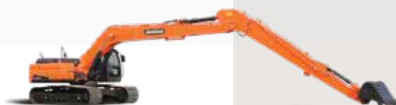
**Flèche articulée ou à grande portée** : avec le groupe de travail à grande portée (17,50 m), cette machine convient idéalement à de nombreuses applications spéciales. Equipée de la flèche articulée, elle offre une polyvalence d'application maximale.
