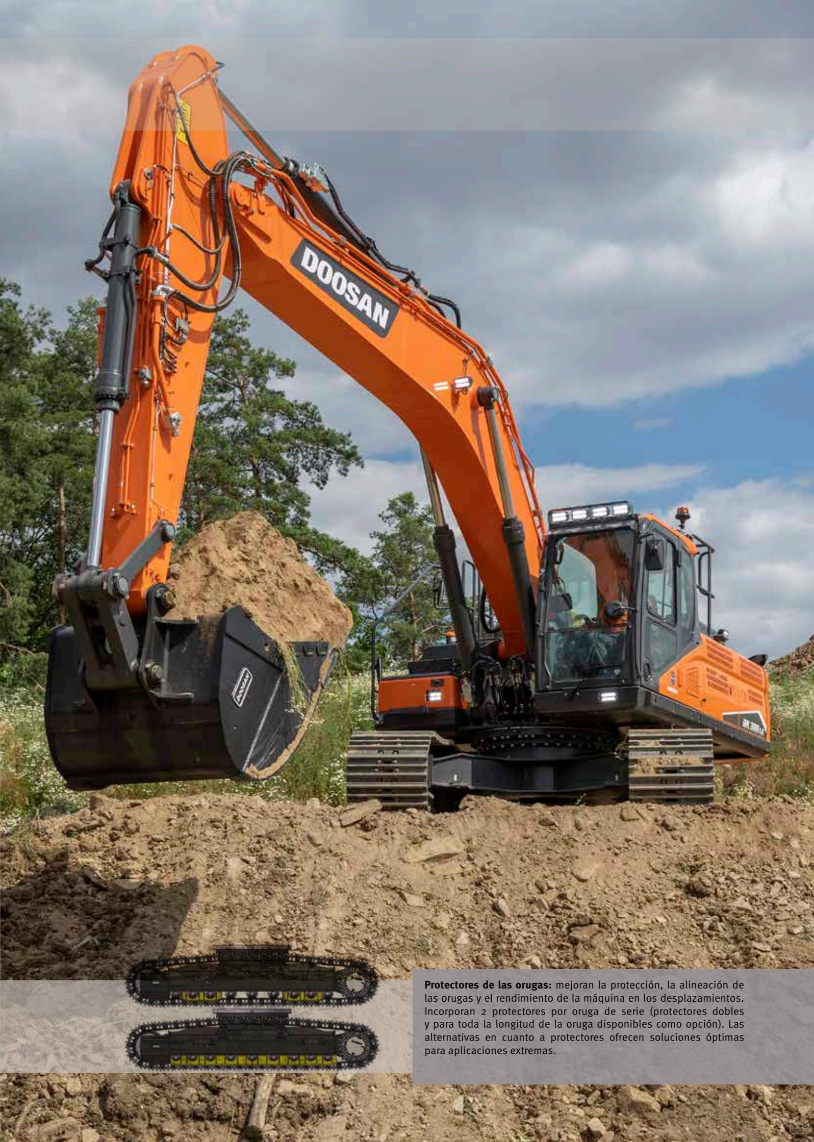
**Protectores de las orugas:** mejoran la protección, la alineación de las orugas y el rendimiento de la máquina en los desplazamientos. Incorporan 2 protectores por oruga de serie (protectores dobles y para toda la longitud de la oruga disponibles como opción). Las alternativas en cuanto a protectores ofrecen soluciones óptimas para aplicaciones extremas.
