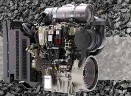
El motor turbodiésel respeta totalmente los límites de la normativa de emisiones Fase IV. Cuenta con inyección de combustible "Common rail" que aporta combustión más eficaz y funcionamiento económico en cualquier tipo de condiciones de trabajo. La ausencia de regeneración de DPF permite que el operador encienda y apague el motor incluso después de giros cortos.
