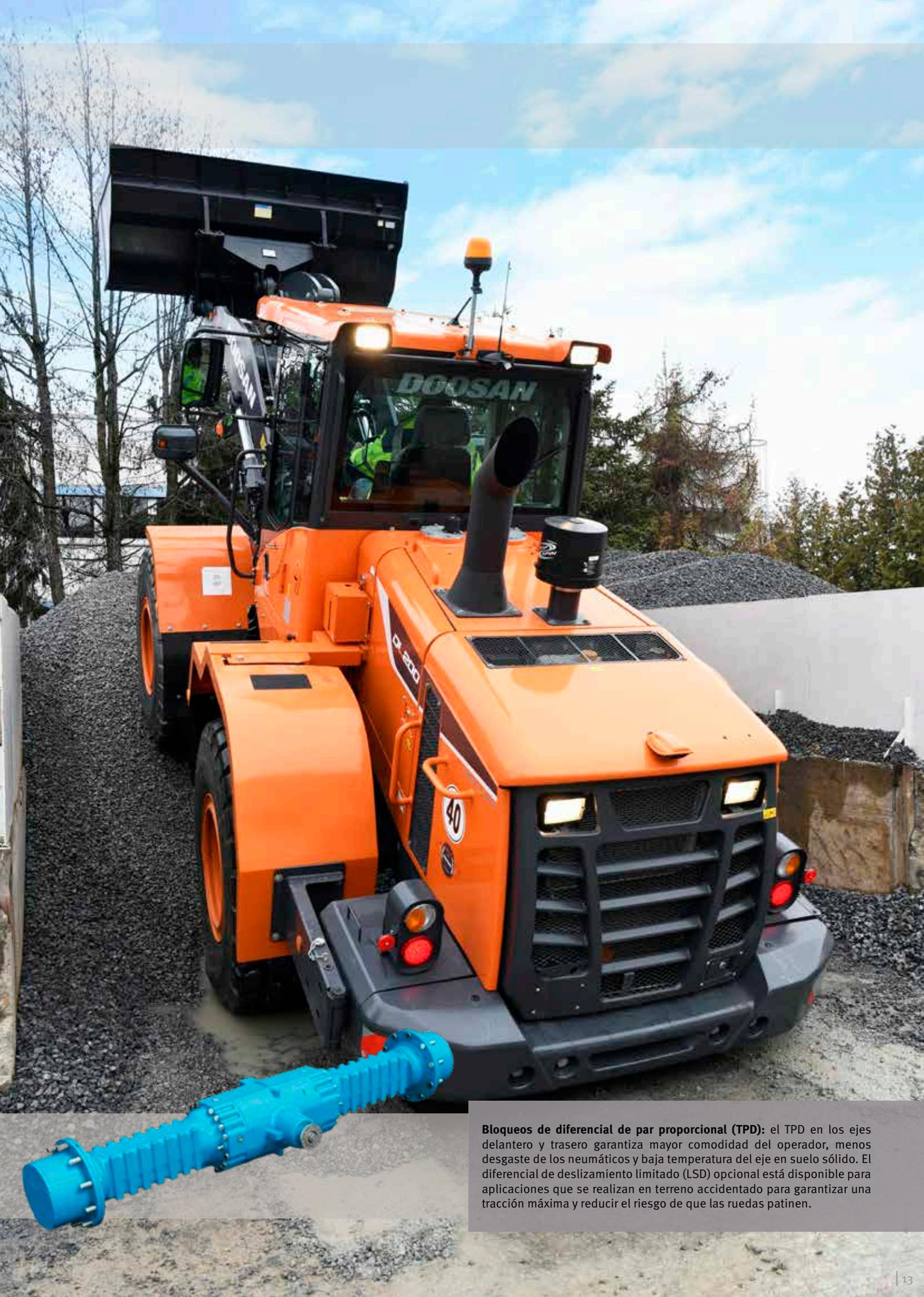
**Bloqueos de diferencial de par proporcional (TPD):** el TPD en los ejes delantero y trasero garantiza mayor comodidad del operador, menos desgaste de los neumáticos y baja temperatura del eje en suelo sólido. El diferencial de deslizamiento limitado (LSD) opcional está disponible para aplicaciones que se realizan en terreno accidentado para garantizar una tracción máxima y reducir el riesgo de que las ruedas patinen.
