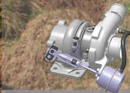
**Turbocompresor con válvula de descarga:** desvía los gases de escape de la turbina para regular mejor la presión máxima de sobrealimentación y proteger el motor. También disminuye el tiempo que pasa antes de que el turbo comience a girar/generar fuerza que maximice el par y además reduce el desgaste en condiciones de régimen elevado y baja carga. El turbocompresor aumenta la densidad del aire, lo que permite al motor producir más potencia sin que influya mucho la altitud.
