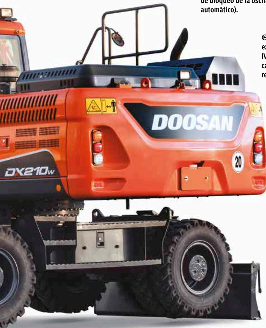
☉ **Durabilidad del bastidor:** El bastidor del chasis y los de los estabilizadores se han reforzado para disminuir tensiones y mejorar la durabilidad.
