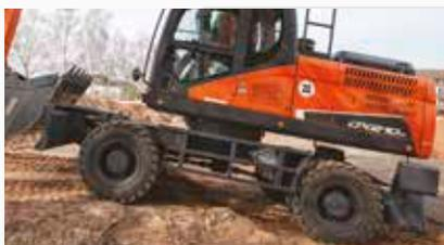
**Estable y confortable:** La mayor distancia entre ejes del mercado para una estabilidad y una capacidad de conducción que marcan la diferencia. Existe una opción disponible de ejes de 2,75 m de ancho.
