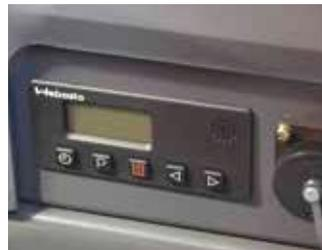
Réchauffeur autonome du circuit de refroidissement
