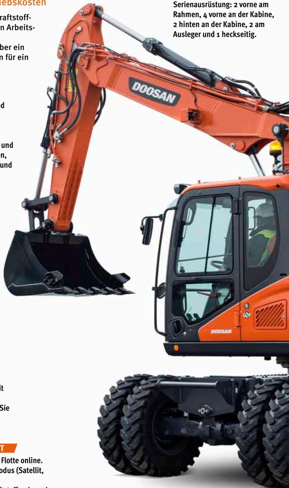
☉ **Vorderachsen-Pendelwinkel:** Sorgt für mehr Komfort. Kann zum Erzielen höherer Hub- bzw. Grabkräfte automatisch oder manuell aktiviert werden. Der DX160W-5 hat eine Hochleistungsachse zur Verbesserung der dynamischen und statischen Achslast.
