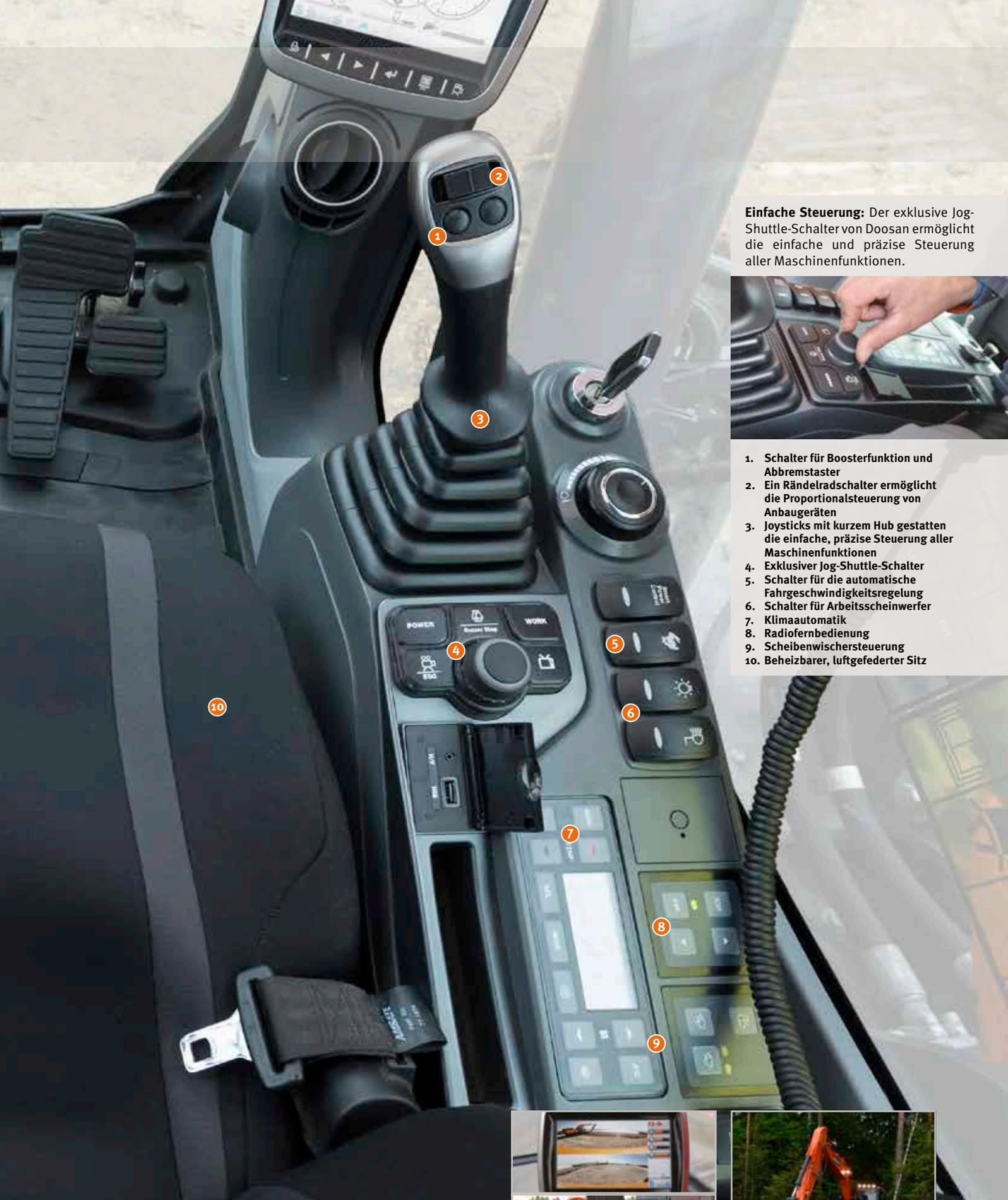
**Einfache Steuerung:** Der exklusive Jog-Shuttle-Schalter von Doosan ermöglicht die einfache und präzise Steuerung aller Maschinenfunktionen.
