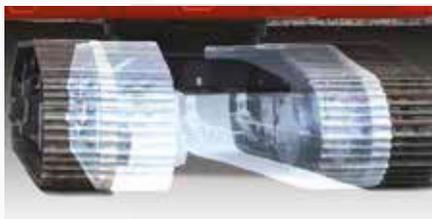
**Sottocarro:** 2,99 m per DX225LC-5 & DX235LC-5; 2,54 m per DX235NLC-5. DX235LC-5 & NLC-5 hanno entrambi larghezza alla torretta di appena 2,54 m. Ciò conferisce al DX235LC-5 un ingombro di rotazione posteriore molto più corto rispetto alle macchine da 20 t convenzionali.
