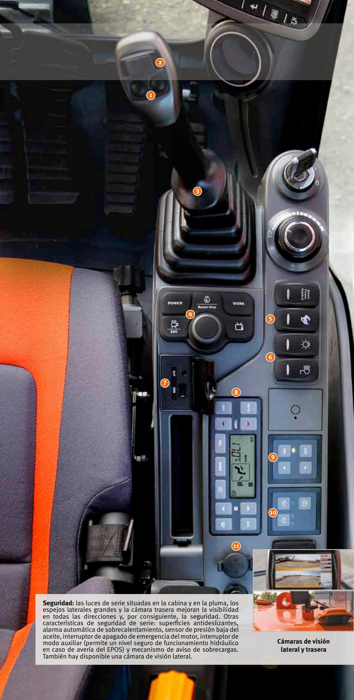
**Control simple:** el exclusivo conmutador giratorio de Doosan proporciona un control sencillo y preciso de todas las funciones de la máquina.
