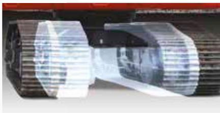
**Tren inferior disponible:** 2,99 m para DX225LC-5 y DX235LC-5 y 2,54 m para DX235NLC-5. Los modelos DX235LC-5 y NLC-5 tienen una estructura superior con un ancho de solo 2,54 m. Esto hace que la DX235LC-5 tenga un giro de voladizo mucho menor que cualquier máquina de 20 t convencional.
