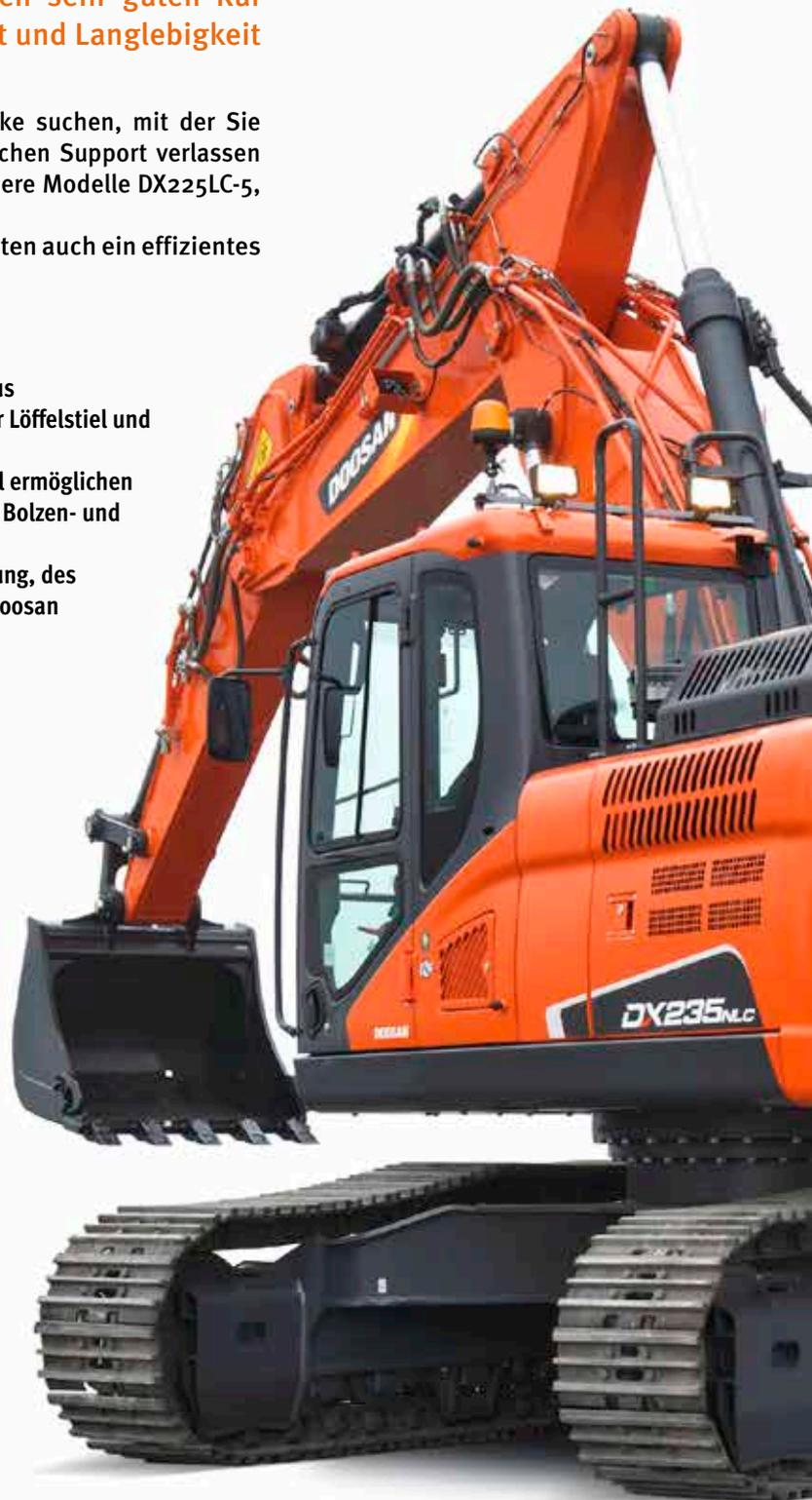
☉ **Komfort:** Eine der geräumigsten Kabinen auf dem Markt mit geringen Geräusch- und Vibrationswerten und hervorragender Rundumsicht. Zur Serienausrüstung gehören ein beheizbarer, voll einstellbarer luftgefederter Sitz sowie eine Automatik-Klimaanlage.
