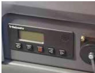
Réchauffeur autonome du circuit de refroidissement
