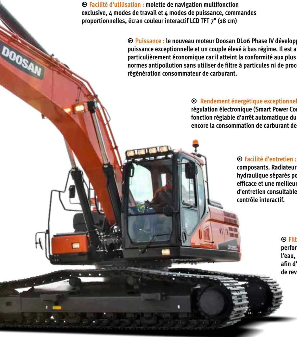
☉ **Train de chenilles particulièrement durable** : galets supérieurs en acier forgé durci en profondeur, galets inférieurs à bain d'huile, barbotins en acier trempé, maillons de chenille en acier trempé durci en profondeur, axes étanches et graissés à vie
