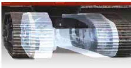
**Châssis inférieurs disponibles** : châssis inférieur étroit / standard : 3,00 / 3,20 m
