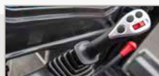
Proportional-Joystick mit Rändelradsteuerung
