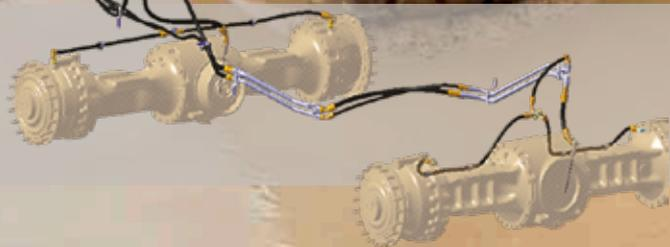
**Refroidissement de l'huile des ponts :** pour assurer des performances maximales, y compris dans les conditions les plus exigeantes, la machine peut être équipée d'un système de refroidissement de l'huile des ponts.
